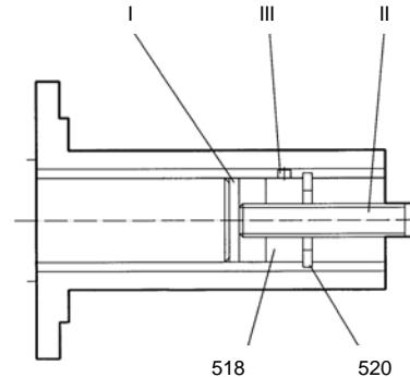
Qualora la rondella / distanziale ruotasse con la vite, assicuarlo con una piccola spina sporgente che possa appoggiare sulla cava linguetta esistente nel foro della puleggia.
