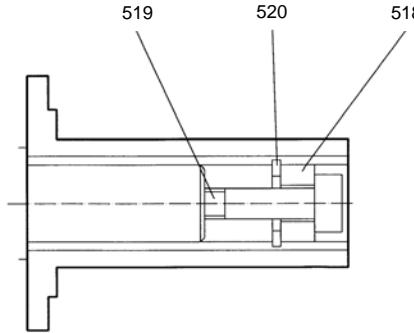
Si la arandela de presión (518) gira también al extraer la polea de ajuste/elástica, asegurarla con un pasador (III) metido en la ranura.
